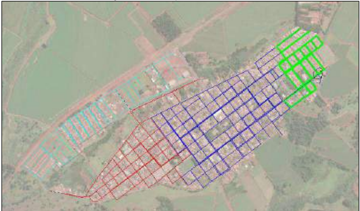
Figura 71: Zona de pressão com Booster.
