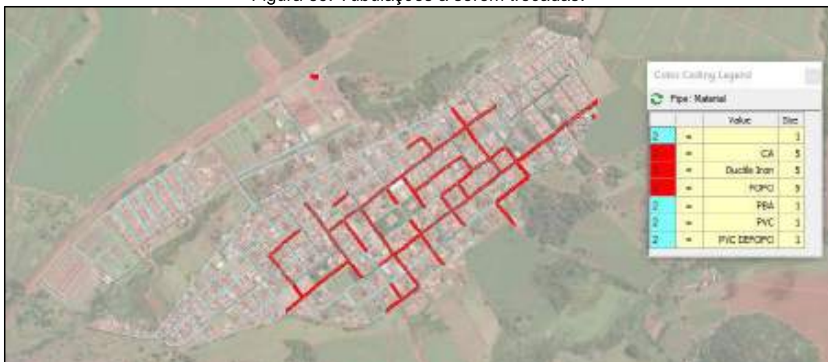
Figura 69: Tubulações a serem trocadas.
