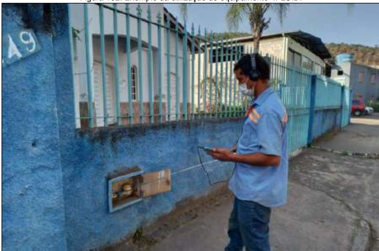
Figura 102: Exemplo da utilização do equipamento 4FLUID.
