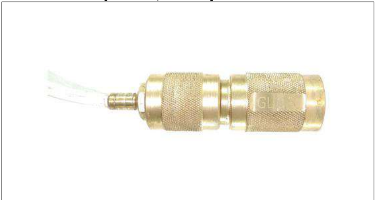
Figura 98: Exemplo de válvula geradora de onda.
